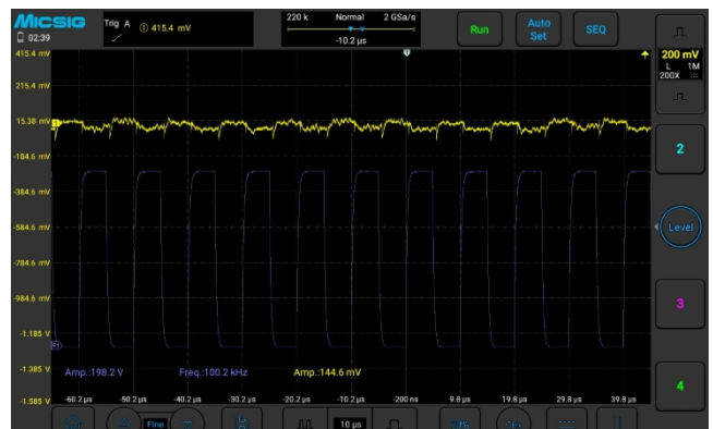
DP700, bei 100 kHz, 198,2 V, Ausgangs-Gleichtaktsignalamplitude 144,6 mV, CMRR > -62 dB
