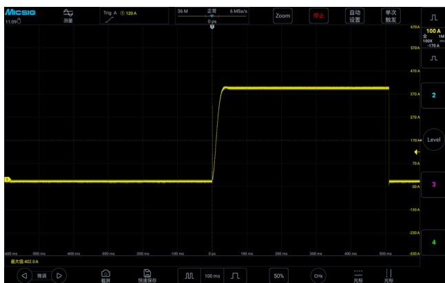
CP3008: Genaue Erfassung von Transienten für 400-A-Hochstromsignale.
