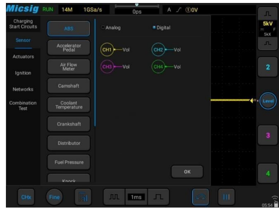
▲ Durch den direkten Vergleich mit Standardwellenformen können die Wellenformen verschiedener Sensoren gemessen werden, wodurch der Benutzer mögliche Probleme leicht erkennen kann.
