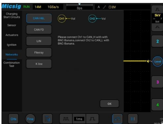
▲ SATO ist in der Lage, CAN High/CAN Low-, CAN FD-, LIN-, FlexRay- und K-Line-Signale zu erfassen und zu decodieren und führt professionelle Netzwerkkommunikationstests an Fahrzeugen durch.
