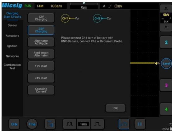
▲ Unterstützt 12/24-V-Lade- und Startstromkreise, Wechselstromwelligkeit und Anlasserstromtests
