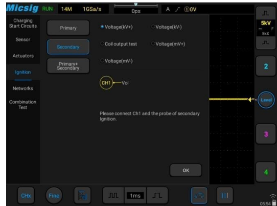
▲ Das Zündsystem eines Autos besteht in der Regel aus Primär- und Sekundärspulen sowie Zündkerzen. Es kann sowohl Primär- als auch Sekundärzündsignale testen, um mögliche Fehlfunktionen zu erkennen.
